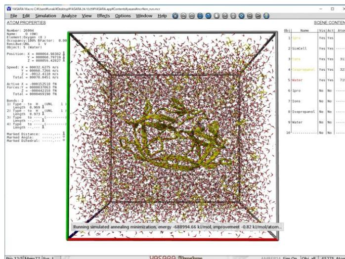
Figure 2-14 溶媒オブジェクトのエネルギー最小化（黄色部分の溶質はFix）
